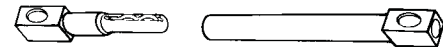
Terminales de alambre de presión de 150 amperios Contactos de bronce sólido con resortes de cobre berilio
