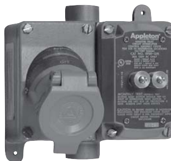
Tapa EFSR-GFI instalada en una caja EFD de una caja rectangular doble junto con un receptáculo sellado de fábrica de 20 amperios, 125 Vca U-Line. Diseñado para uso en Clase I, grupos C y D; clase II, grupos F y G; y clase III
